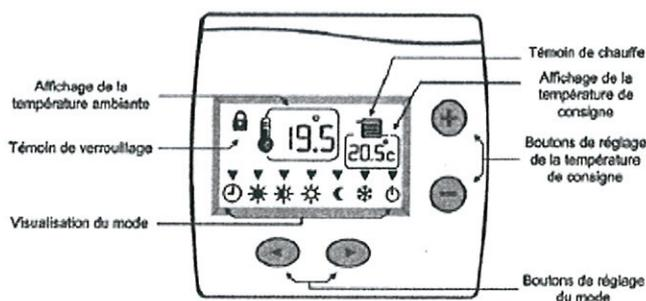
Le thermostat d'ambiance digital semi encastré a été conçu pour vous apporter un maximum de confort. Il est adapté aux installations de chauffage en plancher rayonnant électrique. Il peut se raccorder à un programmeur ou un gestionnaire d'énergie. Il permet de gérer 6 modes de fonctionnement (Confort, Confort-1°C, Confort-2°C, Eco, Hors-gel, Arrêt).
